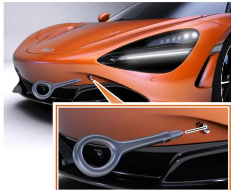
2. Vissez l'anneau de remorquage dans le sens des aiguilles d'une montre dans l'orifice de montage en vous assurant de bien le visser sur toute la longueur du filetage.
