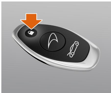
Si l'une des portières ou le capot du compartiment à bagages sont restés ouverts, ou bien si la télécommande de clé se trouve toujours à l'intérieur du véhicule, un signal sonore retentit pour indiquer un verrouillage incorrect quand vous essayez de verrouiller le véhicule.
