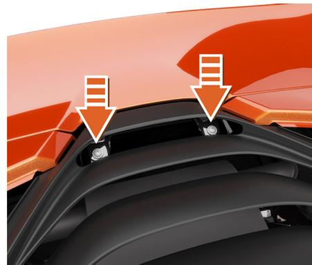
3. À l'aide de l'outil de déverrouillage du capot moteur, faites tourner les deux fixations captives de 90° dans le sens inverse des aiguilles d'une montre pour libérer l'arrière de l'ouïe d'aération arrière.
