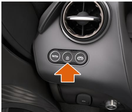
Le bouton de condamnation centralisée s'allume pendant environ 60 secondes suite au verrouillage du véhicule et continue de clignoter passée cette période.
