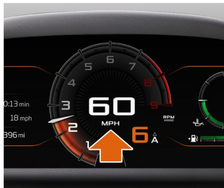
Le compteur de vitesse s'affiche au centre de l'écran du conducteur quand le véhicule est en modes de transmission et de comportement routier Non actif ou Confort.
