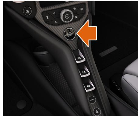
2. Appuyez sur la pédale de frein, appuyez sur le bouton START/STOP (démarrage/arrêt) et relâchez-le : le moteur démarre.
