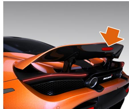
Le troisième feu stop central actif, situé dans l'aéroofrein, s'allume au freinage lorsque l'aéroofrein est déployé étant donné que ce dernier obstrue le troisième feu stop central statique.
