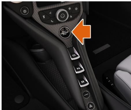
3. Appuyez sur le bouton START/STOP (démarrage/arrêt). Le moteur s'arrête et le véhicule passe à l'état Actif. Reportez-vous à État électrique du véhicule, page 2.04. L'antidémarrage est activé.
