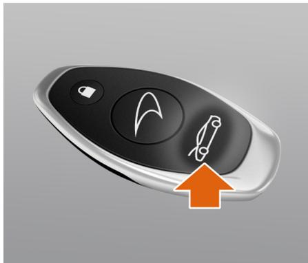
Appuyez sur le bouton d'ouverture du compartiment à bagages de la télécommande de clé. Le compartiment à bagages se déverrouille complètement et s'entrouvre légèrement.
