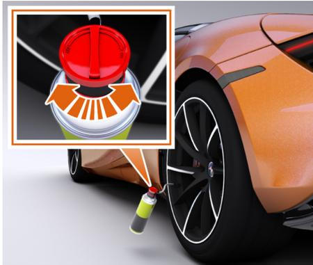
Utilisez le dispositif anticrevaison pour boucher les trous de petite taille, en particulier ceux situés sur la bande de roulement. Le dispositif anticrevaison peut être utilisé à des températures ambiantes descendant jusqu'à -20 °C (-4 °F).
