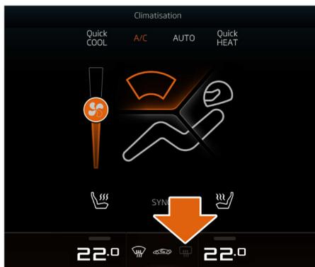
La lunette arrière et les rétroviseurs chauffants se désactivent automatiquement après une durée déterminée, en fonction de la température de l'air extérieur.
