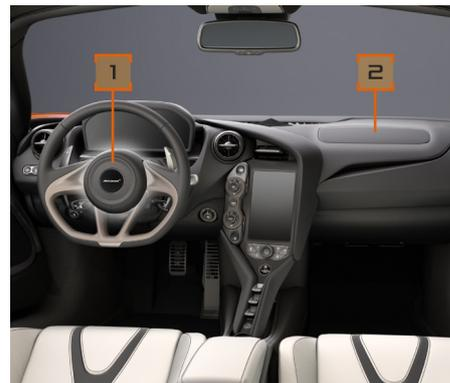
L'airbag avant conducteur (1) se déploie à l'avant du volant et l'airbag avant passager (2) à l'avant et au-dessus du tableau de bord.
