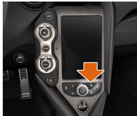
La climatisation fonctionne à l'aide de l'écran tactile de la console centrale d'infodivertissement. Appuyez sur le bouton pour activer l'écran de commande du système de climatisation.
