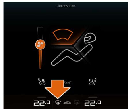
Appuyez sur le bouton de désembuage pour activer la fonction de désembuage à l'écran. Le bouton s'illumine et une icône apparaît en haut de l'écran pour indiquer que la fonction est active. Si elle était éteinte, la climatisation se met en marche et le ventilateur fonctionne à pleine vitesse avec la température de l'air réglée sur « HI ».
