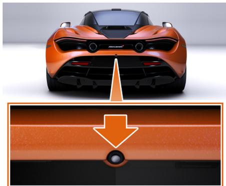
La caméra de recul est placée au centre du pare-chocs arrière. La transmission vidéo apparaît en direct sur l'écran du conducteur quand la fonction est activée.
