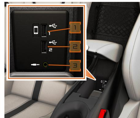
Les ports USB multimédias sont situés à l'intérieur du compartiment de rangement de la console centrale.
