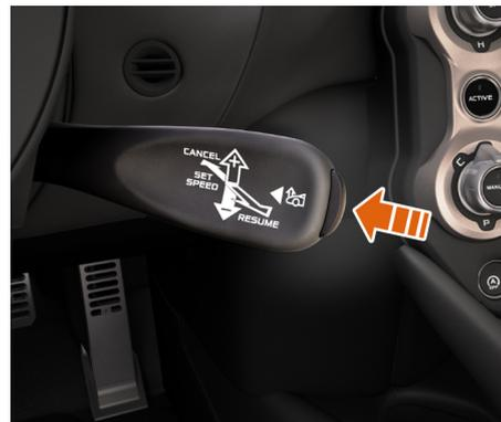
Avant de pouvoir activer le levage du véhicule, il faut mettre le moteur en marche. Pour lever le véhicule à partir de la hauteur de conduite standard, appuyez sur le bouton du commodo situé à droite de la colonne de direction.
