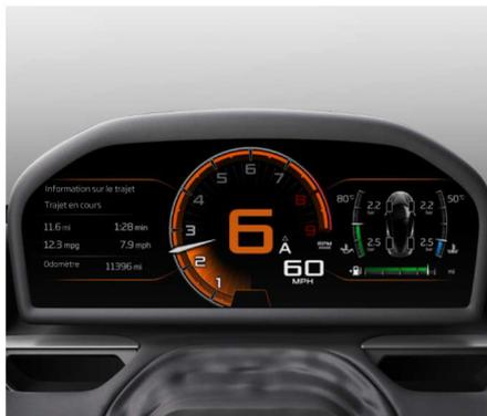
La fenêtre d'affichage fournit au conducteur un accès visuel aux réglages des commandes et aux valeurs de performance actuelles du véhicule. L'écran du conducteur, illustré ci-dessus, s'affiche lorsque le véhicule est en mode Sport.
