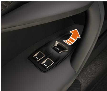
Relevez la poignée de la portière vers le haut, dans le sens de la flèche, et poussez la portière vers l'extérieur jusqu'à ce que le mécanisme d'ouverture s'enclenche. La portière s'ouvre alors automatiquement vers l'extérieur et vers le haut.
