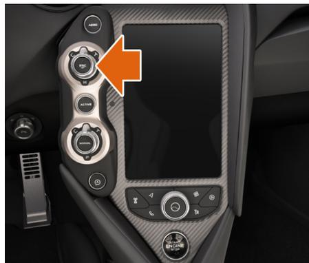
Pour réactiver le contrôle électronique de stabilité (ESC), effectuez l'une des opérations suivantes :
