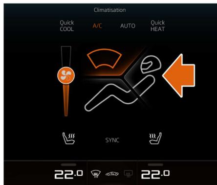
La distribution de l'air peut être réglée via les commandes de distribution de l'air.
