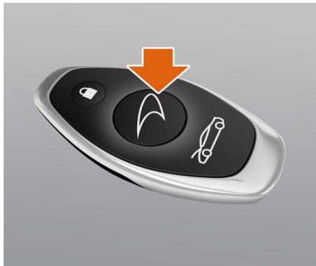
1. Maintenez le bouton de déverrouillage enfoncé pour ouvrir le toit. Si vous relâchez le bouton, le cycle de toit s'arrête jusqu'à ce que vous appuyiez de nouveau sur le bouton.
