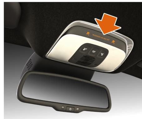
L'état des airbags est indiqué par le témoin d'avertissement PASSENGER AIR BAG OFF (airbag passager désactivé) de la console de plafond.
