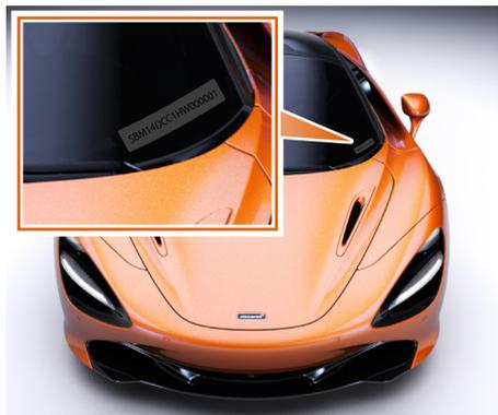
Le numéro d'identification du véhicule figure dans l'angle inférieur gauche du pare-brise.
