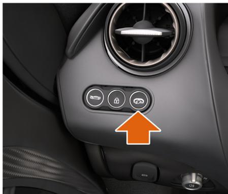
Le mode de déploiement écran du conducteur peut être modifié manuellement, à l'aide du bouton situé sur le tableau de bord.
