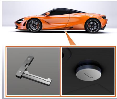
4. Insérez la clé mécanique dans le verrou et faites-la tourner dans le sens inverse des aiguilles d'une montre jusqu'à ce que la résistance mécanique empêche une plus grande ouverture de la portière.
