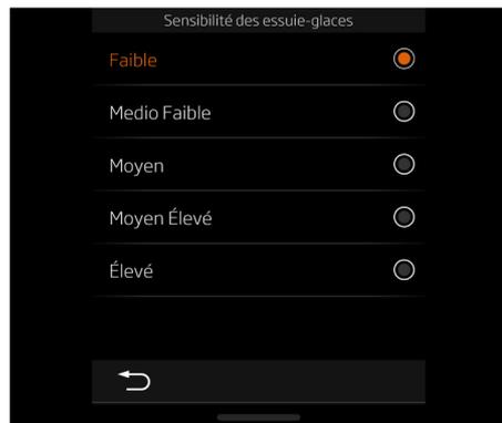
Sélectionnez le niveau de sensibilité en fonction du réglage d'essuie-glace souhaité. Ce paramètre s'applique uniquement au niveau de sensibilité du détecteur de pluie et n'a aucun effet sur la fréquence d'intermittence de l'essuie-glace.
