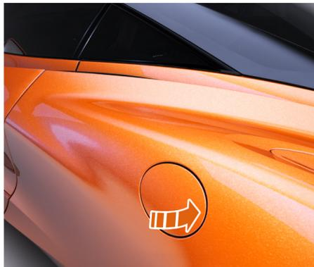
2. Appuyez sur le bord arrière de la trappe à carburant pour la déverrouiller.
