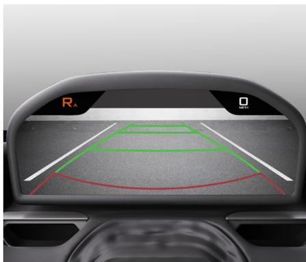
Une grille de couleur est superposée à la transmission vidéo en direct afin de matérialiser la distance entre les objets visibles et l'arrière du véhicule.
