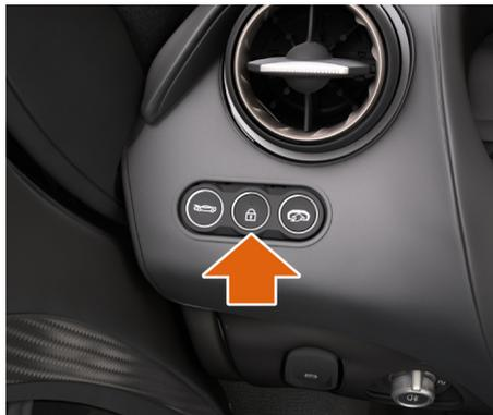
1. Appuyez sur le bouton de condamnation centralisée pour verrouiller le véhicule. Le bouton s'allume pour indiquer que le véhicule est verrouillé. Une portière peut être ouverte depuis l'intérieur du véhicule.
