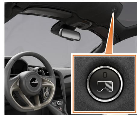
La commande de toit électrochromatique est située sur la garniture de pavillon, entre le conducteur et le passager. Appuyez sur la commande pour activer la fonction, le verre s'éclaircit et la commande s'allume, indiquant que la fonction est activée.
