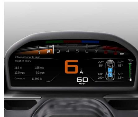
La fenêtre d'affichage fournit au conducteur un accès visuel aux réglages des commandes et aux valeurs de performance actuelles du véhicule. L'écran du conducteur, illustré ci-dessus, s'affiche lorsque le véhicule est en mode Piste.
