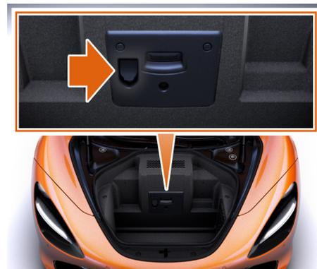
La prise pour accessoires, située dans le compartiment à bagages, a une limite de charge nominale de 20 A. C'est la seule prise pouvant être utilisée pour connecter le chargeur de batterie fourni par McLaren.
