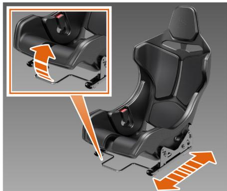
**i** REMARQUE : il est possible de régler la position du siège uniquement vers l'avant et vers l'arrière.
