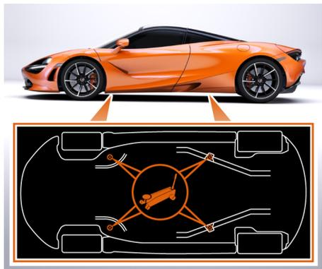
Reportez-vous à l'illustration et aux étiquettes apposées sur le véhicule pour connaître l'emplacement des points de levage.
