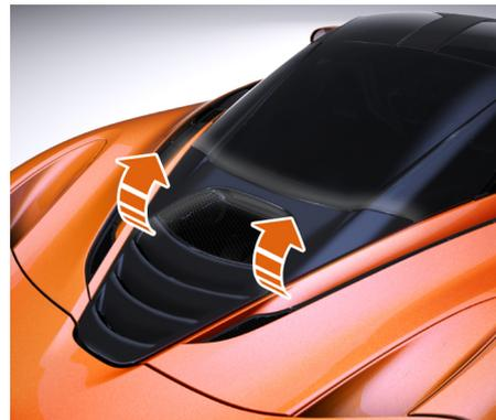
3. Depuis le côté du véhicule, saisissez les deux bords arrière du capot moteur et faites pivoter ce dernier vers le haut en direction de la lunette arrière pour le déposer.
