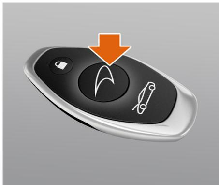
Pour déverrouiller le véhicule à l'aide de la télécommande de clé, appuyez sur le bouton de déverrouillage. Les clignotants avant, arrière et latéraux (selon le marché) clignotent deux fois et le système d'alarme antivol est désactivé.
