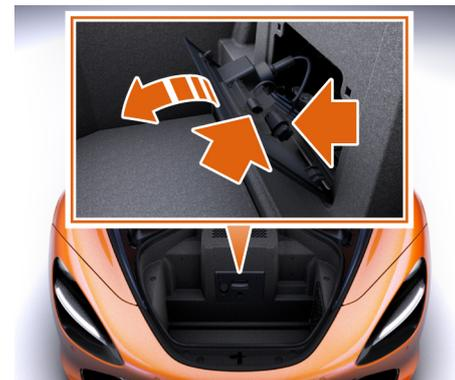
3. Ouvrez la partie supérieure du couvercle d'accès à la batterie et débranchez les 2 connecteurs électriques à l'arrière du couvercle.
