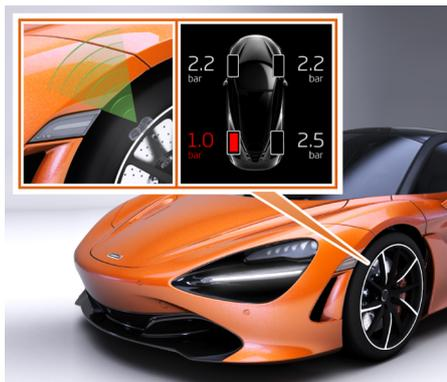
Le système de contrôle de la pression des pneus vous avertit lorsque la pression des pneus chute ou que la température d'au moins l'un des pneus augmente au-delà d'un seuil acceptable.
