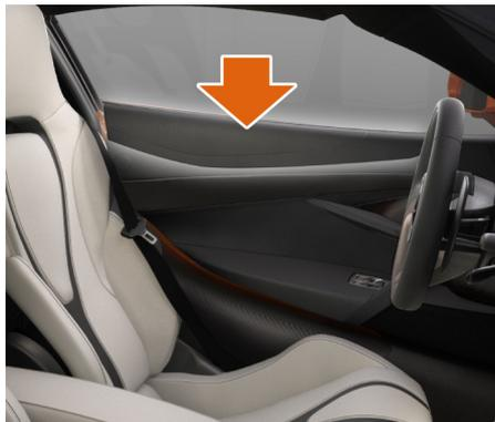
Les airbags latéraux tête se situent dans la zone supérieure de chaque panneau de portière et se déploient si le système considère qu'ils peuvent apporter une protection supplémentaire à la tête de l'occupant sur le côté du véhicule en cas de choc.
