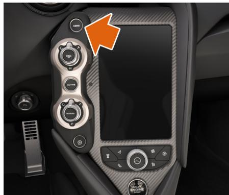
2. Appuyez sur le bouton AERO. L'aéroofrein se relève et se bloque en position d'appui aérodynamique.
