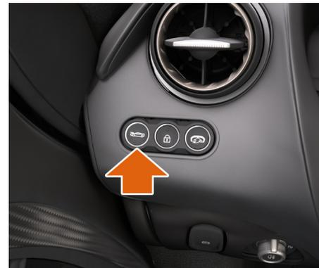
Vous pouvez également appuyer sur le bouton du tableau de bord pour déverrouiller complètement et ouvrir légèrement le compartiment à bagages.
