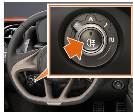
Appuyez sur le bouton du feu antibrouillard arrière situé au centre du contacteur d'éclairage.
