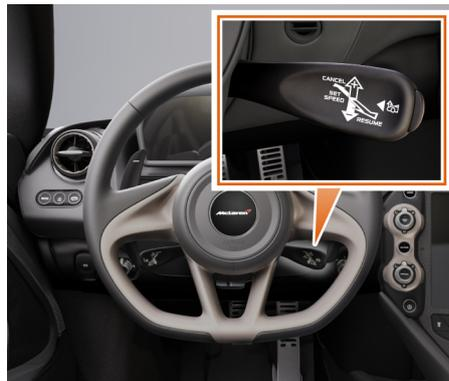
Toutes les fonctions du régulateur de vitesse sont commandées depuis le commodo du régulateur de vitesse, placé à droite de la colonne de direction.
