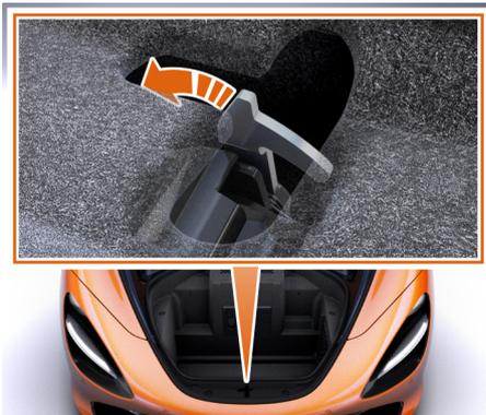
9. Soulevez le capot du compartiment à bagages et relâchez le verrouillage de sécurité.
