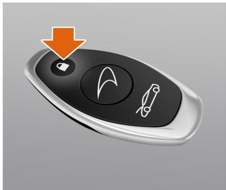
1. Maintenez le bouton de verrouillage enfoncé pour fermer le toit. Si vous relâchez le bouton, le cycle de toit s'arrête jusqu'à ce que vous appuyiez de nouveau sur le bouton.
