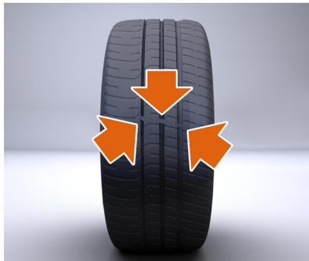
Lorsque la bande de roulement est usée jusqu'à 1,6 mm, les indicateurs d'usure apparaissent à la surface de la structure, formant une bande de caoutchouc continue sur toute la largeur du pneu. Les pneus doivent être remplacés dès que l'indicateur d'usure devient visible ou plus tôt si la législation impose un changement de pneu à une profondeur de bande de roulement supérieure.
