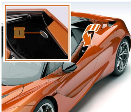
Si la protection anti-pincement reste enclenchée, appuyez sur la commande de verrouillage (1) pendant quelques secondes. La vitre monte jusqu'à ce que vous retiriez votre doigt de la commande de verrouillage. Essayez cela uniquement si les procédures ci-dessus n'ont pas permis de résoudre le problème.
