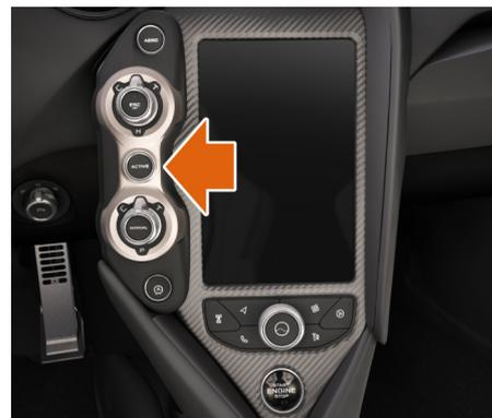
L'actionnement du bouton ACTIVE (activation) allume le panneau de dynamique active. Ceci active les commandes de lancement et le contrôle du comportement routier et de la transmission. Le bouton ACTIVE (activation) et les commandes de comportement routier et transmission s'allument.
