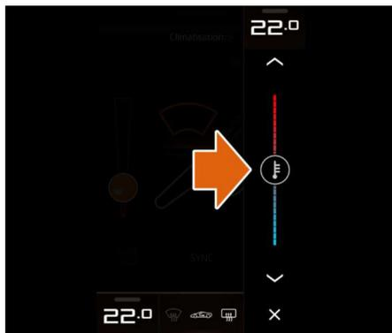
Appuyez sur le bouton ▲ pour augmenter la température ou sur le bouton ▼ pour la faire baisser. Vous pouvez également toucher le curseur de contrôle de la température et le faire glisser jusqu'au réglage souhaité. Pour fermer le curseur de contrôle de la température, touchez le bouton ✕
