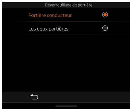
Lorsque **Portière conducteur** est sélectionné, seule la portière du conducteur se déverrouille lorsque le véhicule est déverrouillé à l'aide de la télécommande de clé ou du bouton de portière.
