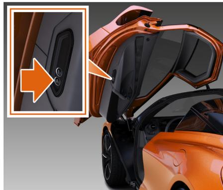
1. Pour désactiver le détecteur de mouvement intérieur, coupez le contact, ouvrez la portière conducteur et appuyez sur le bouton situé sur le bord arrière de cette dernière. Le bouton s'allume pour indiquer que le détecteur de mouvement intérieur est désactivé.
