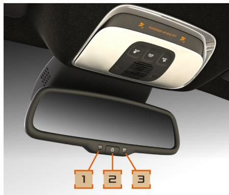
La fonction de gradation automatique du rétroviseur intérieur s'active et se désactive en appuyant sur la commande (2) en partie basse du rétroviseur. Le témoin (1) s'allume lorsque la gradation automatique est active.
