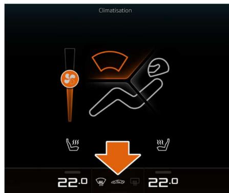
Sélectionnez le mode de recirculation de l'air lorsque des odeurs désagréables ou des fumées pénètrent dans le véhicule. Désormais, l'air provenant de l'extérieur du véhicule ne peut plus entrer dans l'habitacle.
