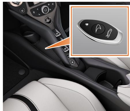
Si la pile de la télécommande de clé est déchargée et que le moteur ne démarre pas, placez la télécommande de clé sur le porte-gobelet, juste derrière le panneau de commande.
