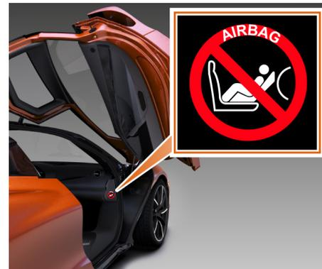
**⚠ AVERTISSEMENT : si le témoin d'avertissement AIRBAG PASSAGER DÉSACTIVÉ n'est pas allumé, n'installez pas de dispositif de retenue pour enfants dos à la route sur le siège passager. Vous pouvez utiliser un dispositif de retenue pour enfants face à la route sur le siège passager. L'étiquette d'avertissement apposée sur le côté passager est là pour vous le rappeler.**
