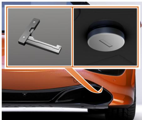
6. Le verrouillage mécanique se situe sur le conduit d'air avant gauche.
