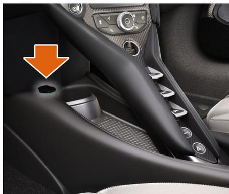
La prise intérieure 12 V pour accessoires se situe à côté du porte-gobelet de la console centrale et a une charge nominale maximale de 15 A.
