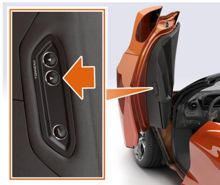
1. Maintenez enfoncé le bouton situé sur le bord arrière de la portière conducteur jusqu'à ce que le hard-top soit complètement fermé.
