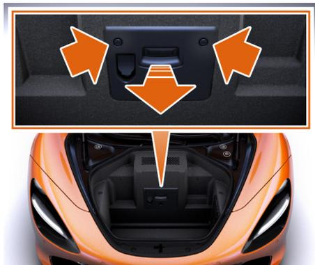
5. Déposez les 2 vis quart de tour qui fixent la partie supérieure du couvercle d'accès à la batterie.
