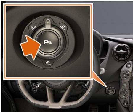
Les détecteurs d'obstacles avertissent le conducteur de chaque obstacle au cours d'une manœuvre à basse vitesse. Ce système est composé de quatre capteurs à ultrasons situés sur le pare-chocs avant, de quatre capteurs à ultrasons situés sur le pare-chocs arrière et de deux bipers. Chaque bipère a un signal différent pour indiquer que l'obstacle est à l'avant ou à l'arrière du véhicule.
