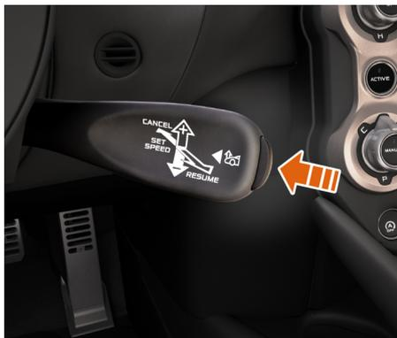
Pour abaisser le véhicule à partir d'une hauteur de conduite relevée, appuyez sur le bouton du commodo situé à droite de la colonne de direction.
