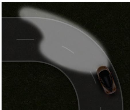
Lorsque les feux sont allumés, l'éclairage dynamique en virage règle le faisceau lumineux dans les virages afin d'améliorer l'éclairage dans le sens de la marche.
