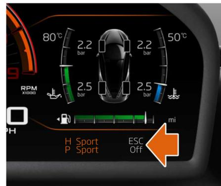
Affiche la confirmation du mode de contrôle électronique de stabilité (ESC) sélectionné. Pour plus d'informations sur les différents paramètres disponibles, reportez-vous à la section Contrôle de la dynamique active, page 2.26.
