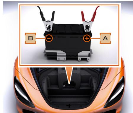
8. Branchez une extrémité du câble de démarrage positif (+) à la borne positive (+) de la batterie du véhicule donneur.
