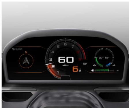
La fenêtre d'affichage fournit au conducteur un accès visuel aux réglages des commandes et aux valeurs de performance actuelles du véhicule. L'écran du conducteur, illustré ci-dessus, s'affiche lorsque le véhicule est en mode Non actif/Confort.
