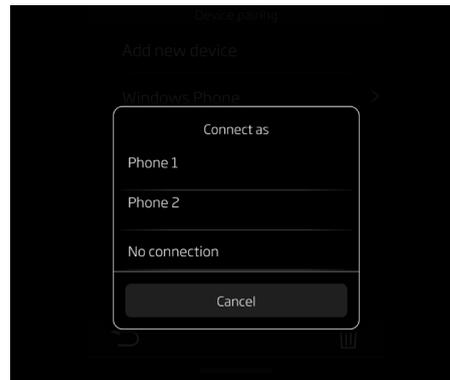
7. Une fois que votre téléphone est jumelé et connecté avec le MIS, sélectionnez si vous souhaitez le connecter en tant que Téléphone 1 ou Téléphone 2. Sélectionnez Aucune connexion si le périphérique Bluetooth® est uniquement utilisé pour le streaming audio.
