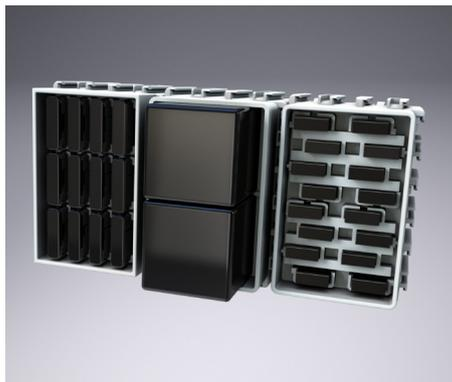
5. Retirez le fusible approprié et remplacez-le par un fusible présentant les mêmes caractéristiques que celui d'origine. En cas de doute, consultez le tableau de caractéristiques des fusibles. Pour cela, reportez-vous à Tableau de caractéristiques des fusibles du boîtier à fusibles secondaire, page 6.26.
