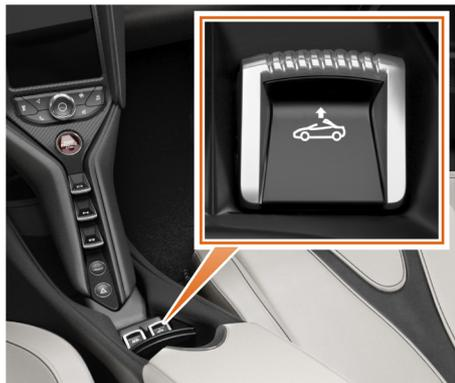
2. Tirez et maintenez la commande dans cette position jusqu'à ce que le toit soit complètement relevé (fermé). Si vous relâchez le commutateur, le cycle de toit est interrompu jusqu'à ce que vous tiriez de nouveau sur le commutateur.
