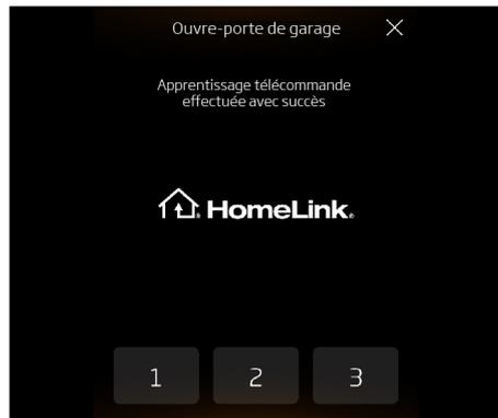
3. Appuyez sur le bouton de la télécommande de l'ouvre-porte de garage et maintenez-le enfoncé. Le message « Apprentissage télécommande effectuée avec succès » s'affiche sur l'écran tactile de la console centrale d'infodivertissement et l'éclairage extérieur clignote. Relâchez le bouton de contrôle de la télécommande du dispositif d'ouverture de porte de garage.
