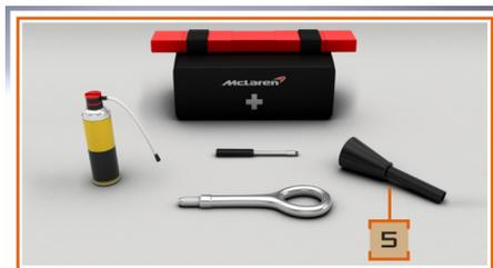
L'entonnoir à carburant (5) est fourni avec le véhicule.
