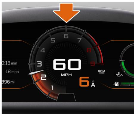
Le tachymètre s'affiche au centre de l'écran du conducteur quand le véhicule est en modes de transmission et de comportement routier Non actif ou Confort. Le nombre rouge sur l'affichage indique le régime maximal du moteur.
