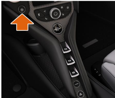
Appuyez sur le bouton d'arrêt du système Eco Start-Stop pour désactiver le système. Le témoin lumineux du bouton s'allume et le témoin d'état de l'écran du conducteur s'éteint.
