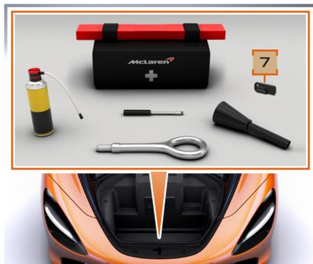
Le support de la clé de déverrouillage manuel des portières (7) est fourni avec le véhicule.
