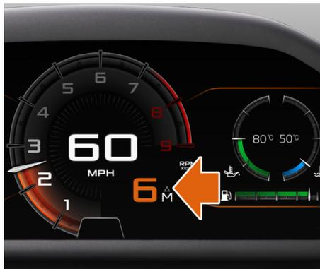
En mode manuel et avec une conduite plus économique, l'indicateur de changement de rapport (GSI) s'allume lorsqu'un passage à la vitesse supérieure permettrait de maintenir les performances optimales. Le GSI ne s'allume pas si l'accélération ou la décélération requise ne peut pas être atteinte avec une vitesse supérieure. Reportez-vous à la section Conduite économique, page 2.15.
