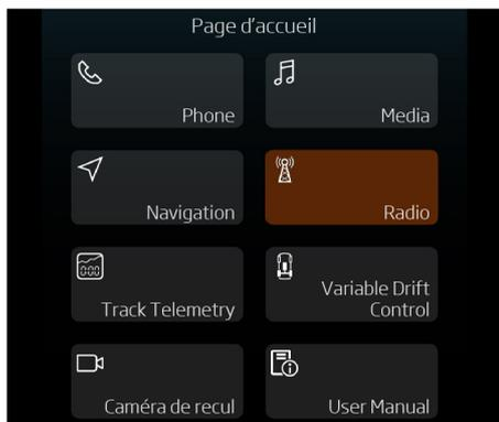
Lorsque vous sélectionnez Radio à partir de l'écran d'accueil du Système d'infodivertissement McLaren (MIS) ou avec le bouton Radio, la radio se met en marche, s'ajuste sur la dernière station sélectionnée et commence à diffuser.
