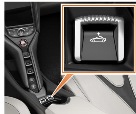
2. Maintenez la commande enfoncée pour ouvrir le toit. Si vous relâchez le commutateur, le cycle de toit est interrompu jusqu'à ce que vous appuyiez de nouveau sur le commutateur.
