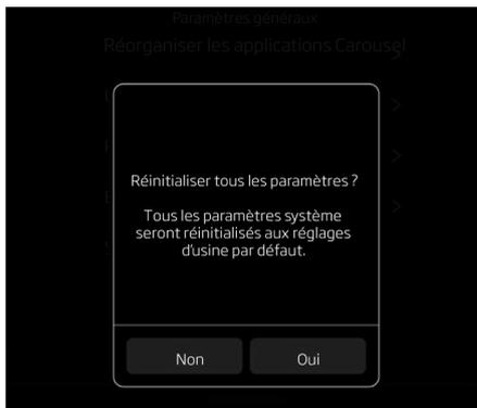
Sélectionnez **Oui** pour réinitialiser tous les paramètres du véhicule et du MIS et rétablir les paramètres d'usine.
