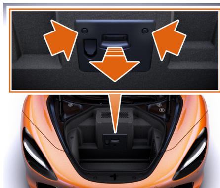
2. Déposez les 2 vis quart de tour qui fixent la partie supérieure du couvercle d'accès à la batterie.
