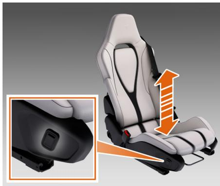
Appuyez sur le haut ou sur le bas de la commande jusqu'à ce que le siège atteigne la hauteur souhaitée.
