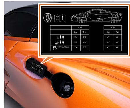
Pour connaître les différentes pressions des pneus en fonction des conditions d'utilisation, reportez-vous à la section Pressions de gonflage à froid des pneus, page 7.13. Ces conditions sont également imprimées sur l'étiquette apposée au niveau de la trappe à carburant.
