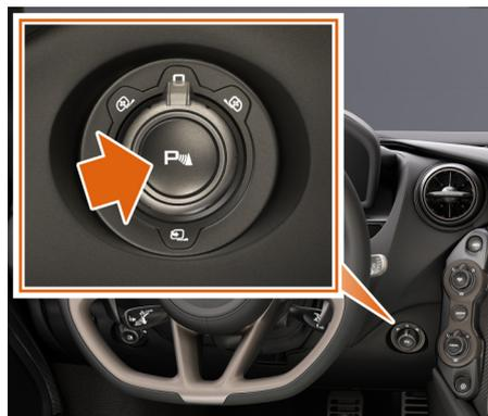
L'Assistance au stationnement 360 permet d'afficher une vidéo en direct sur l'écran tactile de la console centrale d'infodivertissement montrant une vue à 360 degrés autour du véhicule.
