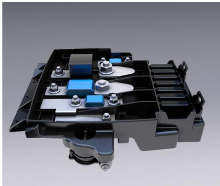
6. Retirez le fusible approprié et remplacez-le par un fusible présentant les mêmes caractéristiques que celui d'origine. En cas de doute, reportez-vous à Tableau de caractéristiques des fusibles du boîtier à fusibles de la batterie, page 6.28.
