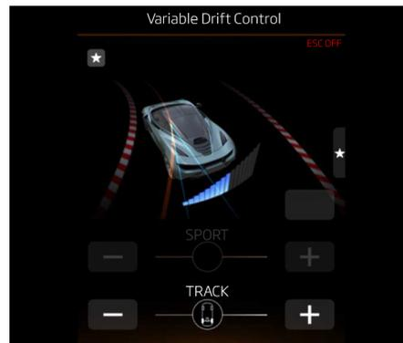
La quantité de dérive permise par l'ESC (contrôle électronique de stabilité) en modes Sport et Piste dynamique est réglable.
