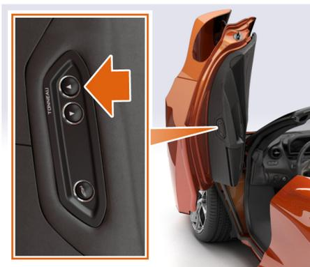
2. Maintenez enfoncé le bouton situé sur le bord arrière de la portière conducteur jusqu'à ce que le hard-top soit complètement ouvert.
