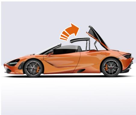
4. Maintenez la commande enfoncée jusqu'à ce que le toit soit totalement ouvert (rangé).
