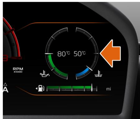
La température de l'eau s'affiche sous forme de jauge colorée sur le côté droit de l'écran du conducteur.
