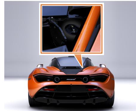
2. Dévissez le bouchon du réservoir d'huile moteur.
