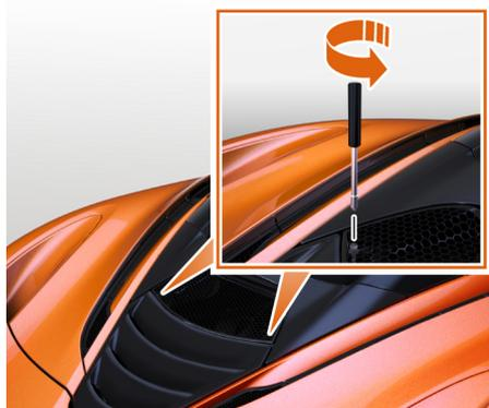
2. Insérez l'outil de déverrouillage du capot moteur dans chaque fixation située sous les coins inférieurs du capot. Faites pivoter chaque fixation à 90° dans le sens inverse des aiguilles d'une montre pour relâcher les deux côtés du capot moteur.
