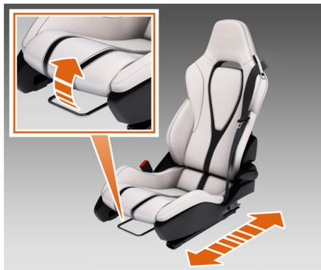
Relevez le levier, déplacez le siège dans la position souhaitée et relâchez le levier pour bloquer le siège.
