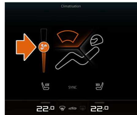
**i REMARQUE :** lorsque le moteur est démarré pour la première fois, la vitesse du ventilateur est limitée et l'air est dirigé vers le pare-brise jusqu'à ce que le moteur ait chauffé.
