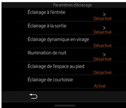
L'éclairage d'entrée et de sortie allume l'éclairage extérieur lorsque le véhicule est verrouillé et déverrouillé. Pour activer ces fonctions, réglez chaque durée sur 15 secondes, 30 secondes, 45 secondes ou 60 secondes. Pour éteindre, sélectionnez Désactivé.
