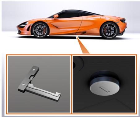
4. Insérez la clé mécanique dans le verrou et faites-la tourner dans le sens inverse des aiguilles d'une montre jusqu'à ce que la résistance mécanique empêche une plus grande ouverture de la portière.
