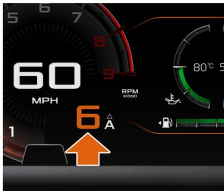
L'indicateur de position de la boîte de vitesses indique la position de la boîte de vitesses actuellement sélectionnée : point mort, rapports 1 à 7 ou marche arrière. L'indicateur affiche également un A ou un M en fonction du mode sélectionné : automatique ou manuel.
