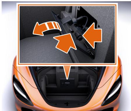
6. Ouvrez la partie supérieure du couvercle d'accès à la batterie et débranchez les 2 connecteurs électriques à l'arrière du couvercle.
