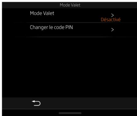
En mode Voiturier activé, la vitesse du véhicule est limitée à 35 mph (55 km/h), le panneau de dynamique active est désactivé, le compartiment à bagages, le compartiment de rangement de la console centrale (sauf modèles 765LT) et le capot moteur restent verrouillés, et un message de confirmation s'affiche sur le groupe d'instruments.
