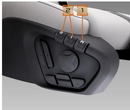
Appuyez sur le bouton (2) où est enregistré le réglage souhaité et maintenez-le enfoncé jusqu'à ce que le siège, les rétroviseurs extérieurs et le volant aient terminé leur réglage.
