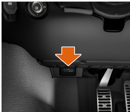
将诊断工具连接到 OBD 端口，从 ECU 读取 VIN。
