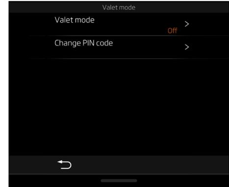
발렛 모드를 켜면 차량 속도가 55km/h로 제한되고 액티브 다이내믹스 패널이 비활성화되며 러기지 컴파트먼트, 센터 콘솔 보관함(765LT 제외) 및 서비스 커버가 잠긴 상태로 유지되고 계기판에 확인 메시지가 나타납니다.
