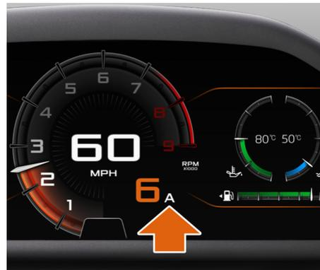
변속 장치 모드 표시기에 A가 표시됩니다. 모든 기어 변속이 자동으로 실행되지만 기어 변속 패들을 작동하면 변속 장치가 일시적으로 수동 모드가 됩니다. 이 모드는 운전자가 8초 이상의 간격 없이 수동 기어 변속을 계속하는 한 활성 상태로 유지됩니다. 변속 장치 모드 표시기에 A/M이 표시됩니다(기어 위치 표시기, 페이지 3.17 섹션 참조).
