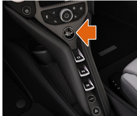
3. START/STOP 버튼을 누릅니다. 엔진이 정지하고 차량이 활성 모드에 진입합니다(차량 전기 상태, 페이지 2.02 섹션 참조). 이모빌라이저가 활성화됩니다.
