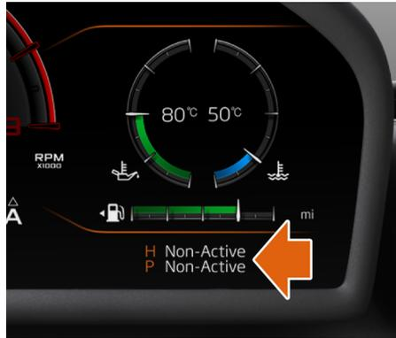
ACTIVE 버튼을 누르지 않으면(액티브 다이내믹스 패넬이 꺼져 있으면) 핸들링 및 파워트레인 디스플레이에 모두 Non-Active(비능동형)가 표시되며 디스플레이가 흰색으로 표시됩니다. 모든 사전 조건이 충족되지 않으면 모드가 실행되지 않습니다. 핸들링 및 파워트레인 모드를 선택했는지 여부가 표시됩니다. 사용 가능한 다양한 설정에 대한 자세한 내용은 액티브 다이내믹스 컨트롤, 페이지 2.19 섹션을 참조하십시오.
