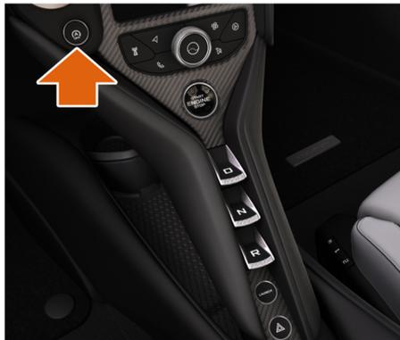
ECO Start-Stop 시스템 OFF 버튼을 눌러 시스템을 비활성화합니다. 버튼의 표시등이 켜지고 접이식 운전자 디스플레이의 상태 표시등이 꺼집니다.
