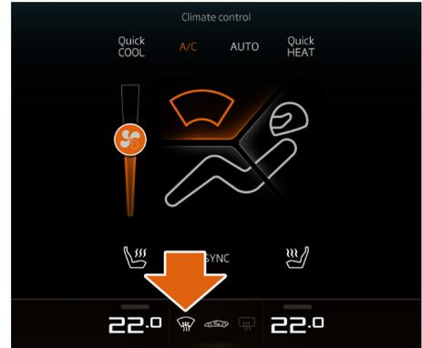
성에 제거 버튼을 터치하여 화면에서 성에 제거 기능을 활성화합니다. 버튼에 불이 들어 오고 화면 상단에 기능이 활성 상태를 나타내는 아이콘이 표시됩니다. 에어컨 스위치가 꺼져 있었다면 켜지고 공기 온도가 'H'로 설정되어 블로워가 최대 속도로 작동합니다.
