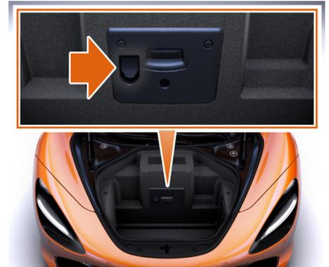
배터리 충전기와 함께 제공된 지침을 참조하십시오. 충전기는 러기지 컴파트먼트의 액세스리 소켓에 연결합니다.
