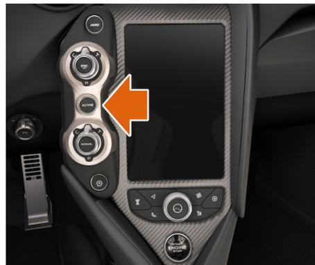
ACTIVE 버튼 스위치를 누르면 액티브 다이내믹스 패널이 켜집니다. 론치, Aero, ESC Off, 핸들링 및 파워트레인 컨트롤이 활성화됩니다. ACTIVE 버튼과 핸들링 및 파워트레인 스위치에 불이 들어옵니다.
