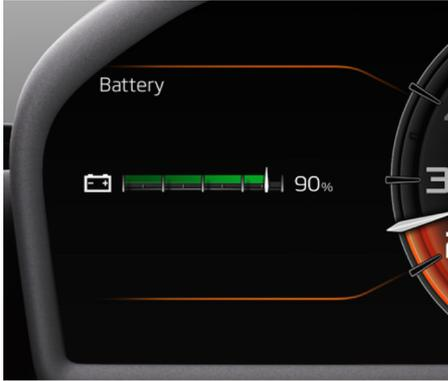
배터리 충전 상태를 보여 주는 게이지를 표시합니다. 배터리를 충전하려면 배터리 충전, 페이지 6.14 섹션을 참조하십시오.
