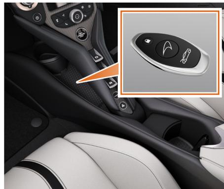
키 리모컨 배터리가 방전되고 엔진의 시동이 걸리지 않을 경우, 키 리모컨을 스위치 패널 바로 뒤의 컵 홀더 하우징 부분에 올려 놓으십시오.
