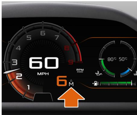
변속 장치 모드 표시기에 M과 현재 선택된 기어가 표시됩니다. 모든 전진 기어 변경은 기어 변속 패들을 작동시켜 수행합니다(기어 변속 패들, 페이지 2.18 섹션 참조).
