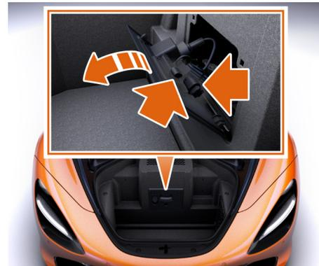
3. 배터리 액세스 커버 상단을 열고 커버 뒤쪽의 전기 커넥터 2개를 분리하십시오.
