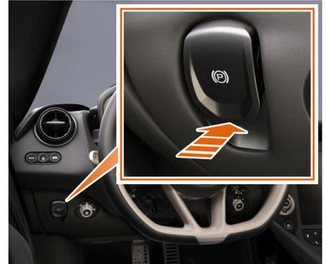
주차 브레이크를 해제하려면 브레이크 페달을 밟은 상태로 주차 브레이크 스위치를 안쪽으로 밟습니다. 접이식 운전자 디스플레이에서 빨간색 주차 브레이크 적용 상태 표시등이 꺼집니다.
