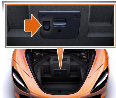
러그지 컴파트먼트 안에 위치한 액세서리 소켓의 최대 정격 부하는 20A이며 McLaren 제공 배터리 충전기를 연결할 수 있는 유일한 위치입니다.
