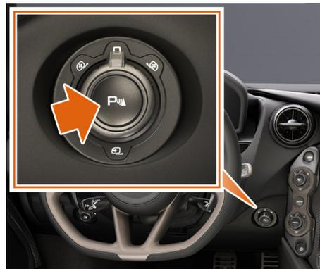
주차 센서는 저속 주행 시 모든 장애물을 운전자에게 경고합니다. 이 시스템은 프론트 범퍼에 위치한 초음파 센서 4개, 리어 범퍼에 위치한 초음파 센서 4개 및 경보 발생기 2개로 구성되어 있습니다. 각 경보 발생기는 음 높이가 다르기 때문에 장애물이 차량 전방에 있는지, 아니면 후방에 있는지 구분할 수 있습니다.
