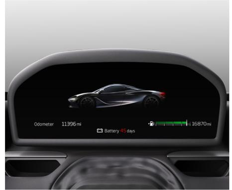
차량이 활성 모드인 경우 남은 "주차 일 수"가 접이식 운전자 디스플레이에 표시됩니다. 이 기간은 엔진을 작동하거나 배터리 충전을 연결하지 않은 상태로 배터리가 방전되기 전까지 차량을 주차할 수 있는 일수를 나타냅니다.
