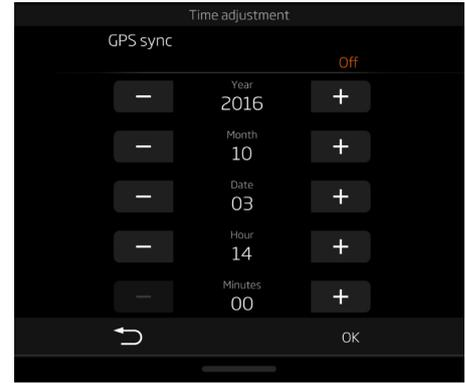
GPS 신호를 사용하여 자동으로 시간을 조정하려면 GPS sync(GPS 동기화)를 선택합니다. GPS sync(GPS 동기화)가 활성화되면 On이 강조 표시됩니다.
