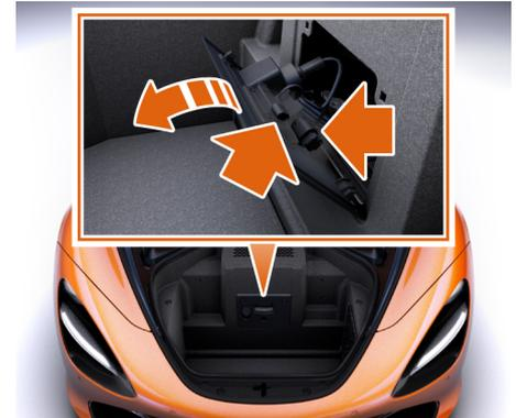
6. 배터리 액세스 커버 상단을 열고 커버 뒤쪽의 전기 커넥터 2개를 분리하십시오.
