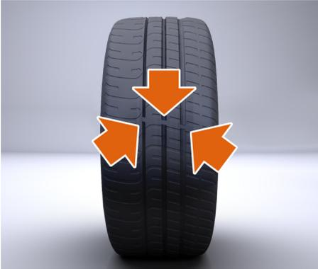
트레드가 1.6mm 이상 마모된 경우, 마모 표시가 트레드 패턴 표면에 나타나고 타이어 폭 전체에 걸쳐 연속된 고무 띠가 형성됩니다. 마모 표시가 눈에 보이는 즉시 타이어를 교체해야 하며, 더 깊은 트레드 깊이에서 교체하도록 법으로 규정된 경우에는 보다 조기에 교체해야 합니다.
