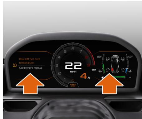
이 화면에 4개 타이어 각각의 현재 온도가 표시됩니다. 온도가 파란색으로 나타나면 아직 타이어가 최적 작동 온도까지 예열되지 않은 것입니다. 온도가 녹색으로 나타나면 조치가 필요하지 않습니다. 온도가 빨간색으로 나타나면 타이어의 안전한 작동 온도가 초과된 것입니다. 온도가 안전한 수준이 될 때까지 즉, 온도가 녹색으로 표시될 때까지 속도를 줄이거나 차량을 정지하십시오.
