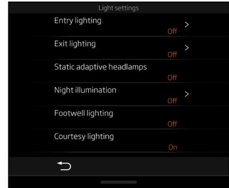
Entry lighting(승차 조명) 및 Exit lighting(하차 조명)은 차량이 잠금 해제될 때와 잠길 때 외부 조명을 켜줍니다. 이러한 기능을 활성화하려면 각 기능의 기간을 15초, 30초, 45초 또는 60초로 설정합니다. 비활성화하려면 Off(꺼짐)를 선택합니다.
